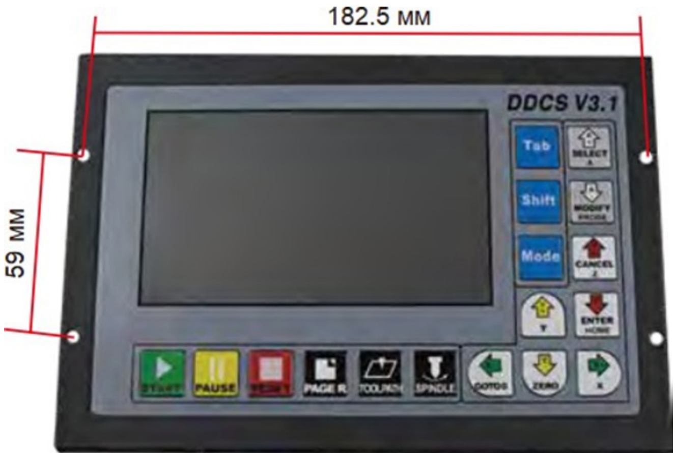
Рис.1.2.1 Вид спереди и размеры монтажных отверстий
